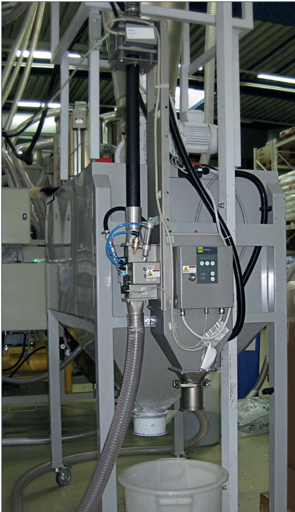
Einbaubeispiel: Metall-Separator GF eingebaut in eine vertikale Förderleitung (alte Ausführung)
