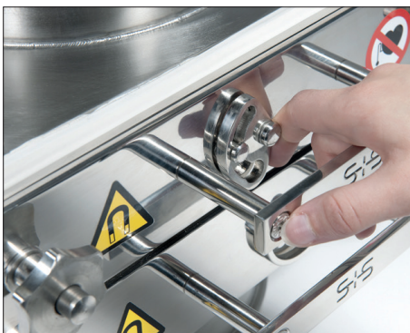
Riegelfallen-Verschluss, um die Magnetkerne aus den Edelstahlhülsen ziehen zu können - EASY CLEAN Abreinigung
